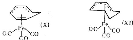
Комплекс с циклогепта-1,3-диеном (XI), который может быть получен не только таким путем, но и прямо при нагревании  $\text{Fe}(\text{CO})_5$  с этим диолефином, вероятно, получается в ходе реакции циклогептатриена с карбонилом железа в результате переноса водорода от избытка триена, имеющегося в реакции, к уже координированному триену.
