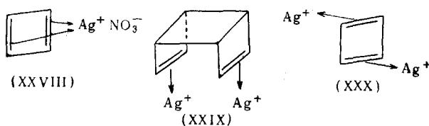
ИК спектр комплекса относительно прост. Полагают, что наиболее вероятна цепочечная структура (XXX), хотя нельзя полностью исключить и структуру (XXVIII), при этом вряд ли следует считать, что циклобутадиеновое кольцо совершенно симметрично<sup>172</sup>. Спектр этого соединения резко отличен от спектра комплекса серебра с циклооктатетраеном.
